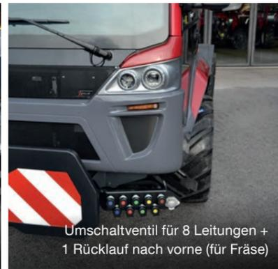
Umschaltventil für 8 Leitungen + 1 Rücklauf nach vorne (für Fräse)
